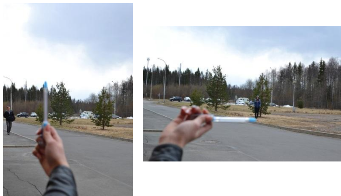
Рисунок 6. Определение высоты дерева методом отложения мерного отрезка.
