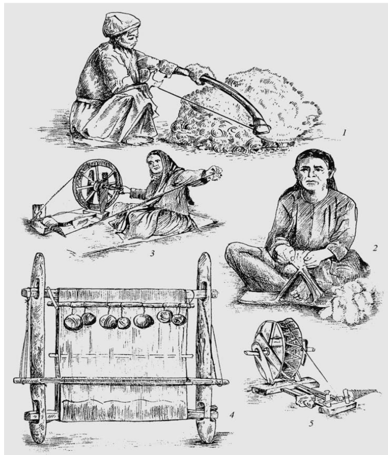
Илл. 53. Обработка шерсти. 1 – лущение шерсти (халладж); 2 – расчесывание; 3 – прядение; 4 – станок (хана); 5 - прялка. Архив Института археологии и этнографии Национальной академии наук Азербайджана.
