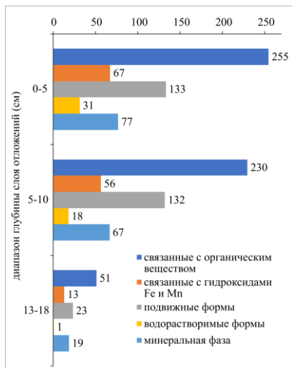
Рисунок 23. Вертикальное распределение Ni в мг/кг в разных формах в колонке ДО оз. Комсомольского (Мончегорск, Мурманская область)
