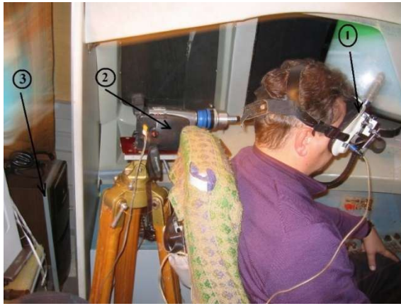
Рисунок 4.1 Общий вид прибора NAC Eye Mark Recorder в кабине КТС Ту-204 и его размещение на голове пилота
