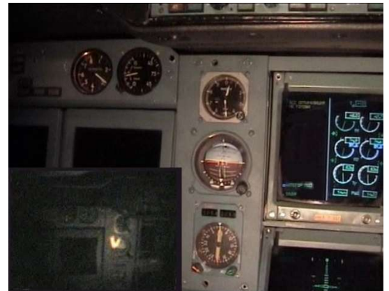
Рисунок 4.2 Изображение записи фиксации взгляда пилота с синхронизацией показаний ПП и метки ТФВ
