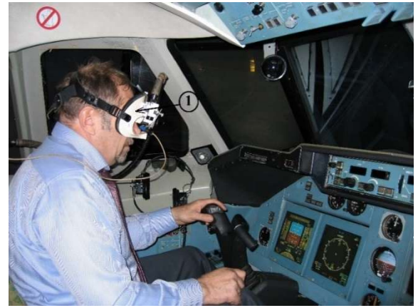
Рисунок 4.1 Общий вид прибора NAC Eye Mark Recorder в кабине КТС Ту-204 и его размещение на голове пилота
