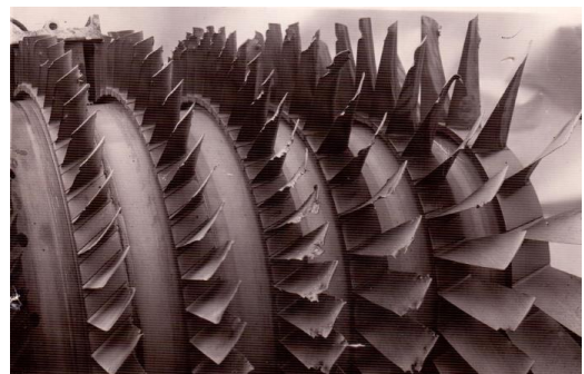
Рисунок П5.10.36-П5.10.37 - Поврежденные лопатки компрессора
