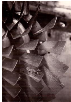
Рисунок П5.10.27-П5.10.29 - Поврежденные лопатки компрессора
