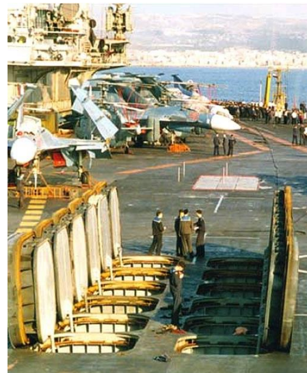
Рисунок П5.3.16 - ПУ СМ-233 на тавкр проекта 1143.5
