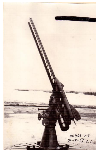
Рисунок П5.10.8 - Станок 21-к с направляющей М-13
