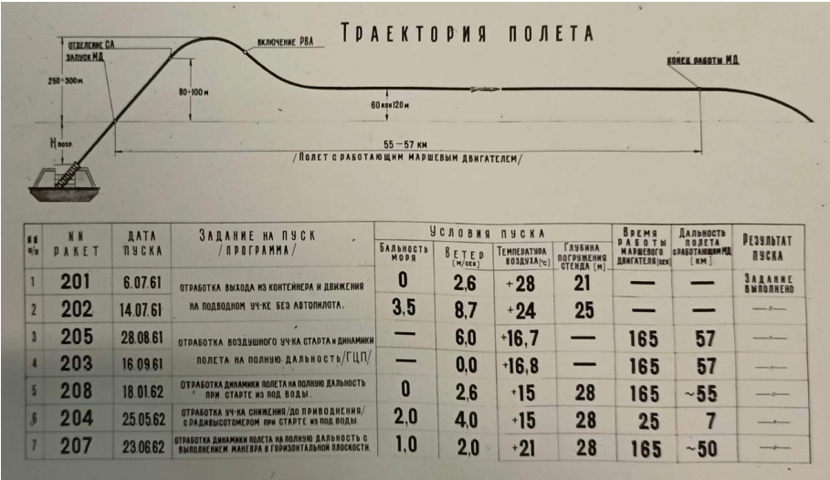
Рисунок П5.9.20 - Результаты испытаний ракеты «Аметист» с притапливаемого стенда и наземной пусковой установки
