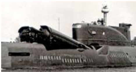
Рисунок П5.3.5 - ПУ ПКР П-6 на пл проекта 651
