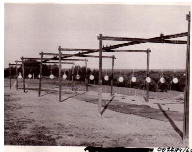
Рисунок П5.10.33-П5.10.35 - Моделирование воздействия ударной волны
