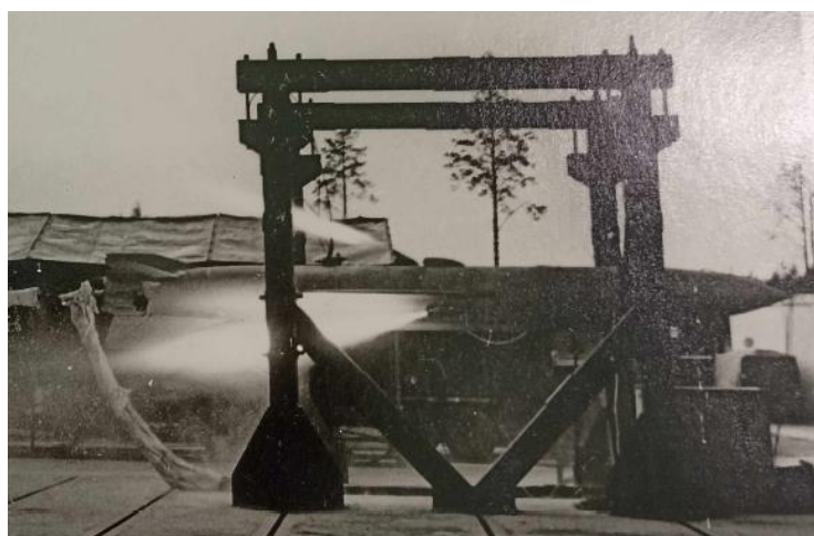
Рисунок П5.9.2 - Нормальная работа маршевого двигателя
