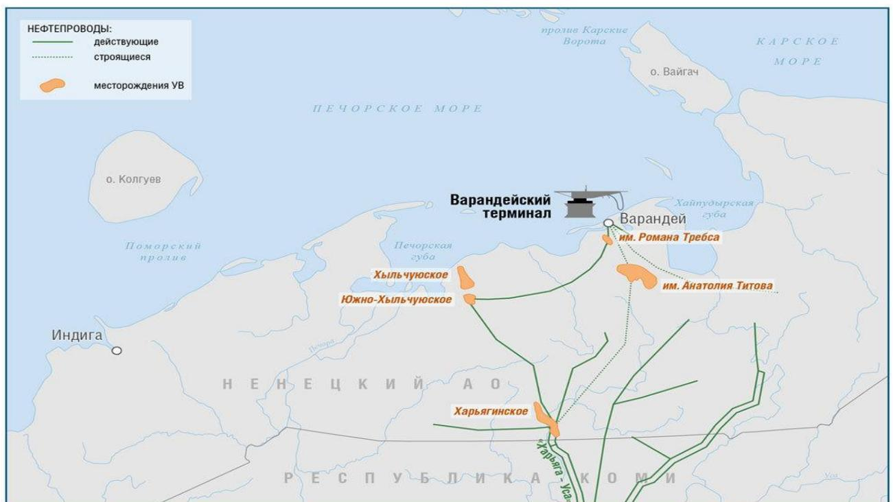
Рисунок 53 – Схема транспортировки нефти с ряда месторождений Ненецкого АО
