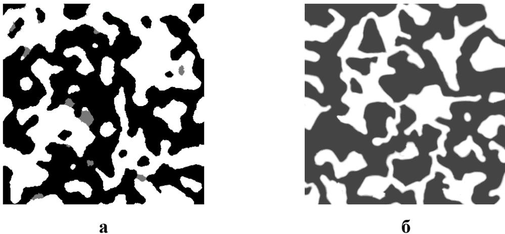
Рис. 2.1. Структура пленки висмута. Черным цветом обозначены кристаллиты одной устойчивой ориентации, белым – другой.
