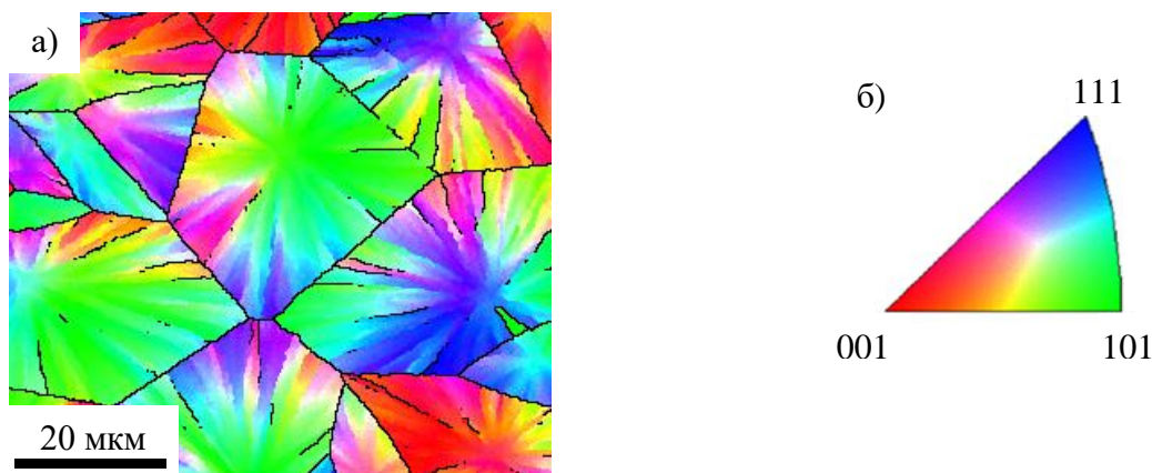
Рисунок 4 – Карта кристаллографических ориентаций тонкой пленки ЦТС (а), сформированной на подложке Pt/TiO 2 /SiO 2 /Si, и треугольник цветокодирования карт кристаллографических ориентаций (б)
