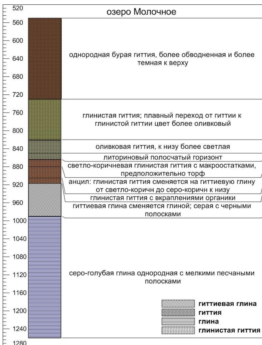
Рис. 30. Литологическое описание керна ДО оз. Б. Молочное.
