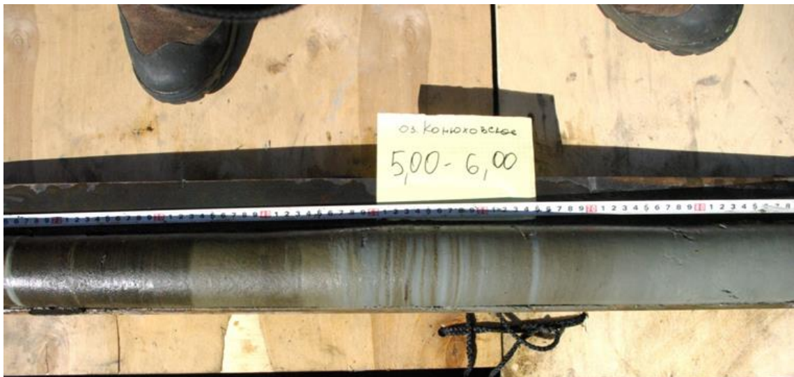
Рис. 3.3 Переход от минеральных, глинистых отложений к голоценовым органическим гиттиям с чередованием в переходной зоне более органическим и минеральных прослоев. Оз. Конюховское, Онежский п-ов Белого моря, 16 м над у.м.
