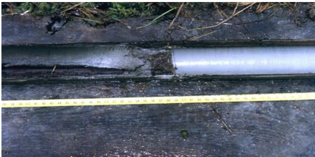
Рис. 3.1 Переход от позднеплейстоценовых минеральных, глинистых отложений к органическим илам – гиттиям. Контакт резкий, эрозионный. Оз. Мянтюламп, Карельский перешеек, 12 м над у.м.
