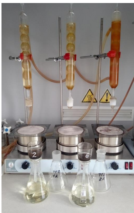
Рисунок 13 – Установка для экстракции и гидролиза (колбонагреватель и обратные холодильники)
