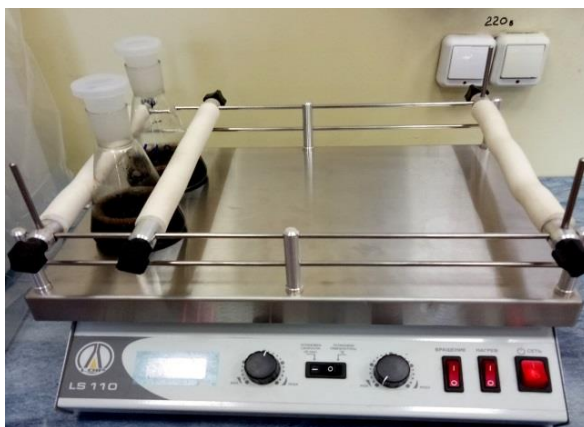
Рисунок 11 – Лабораторный шейкер (установка для метода настаивания)
