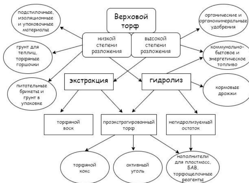
Рисунок 2 – Схема возможного комплексного использования верхового торфа (Соколов, Ивко, 2000)
