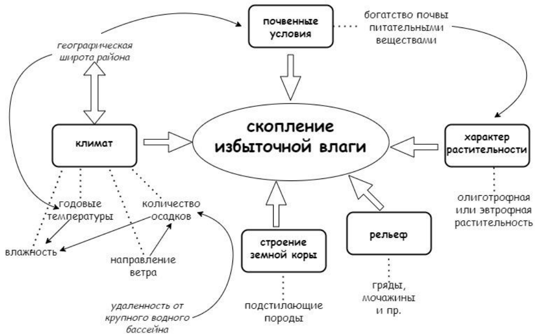
Рисунок 14 – Блок-схема факторов, влияющих на свойства торфа (составлено автором)
