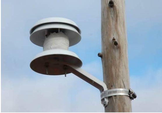
А) датчик для измерения температуры воздуха
