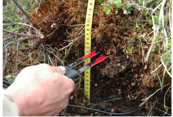
Б) датчик для измерения параметров почвы
