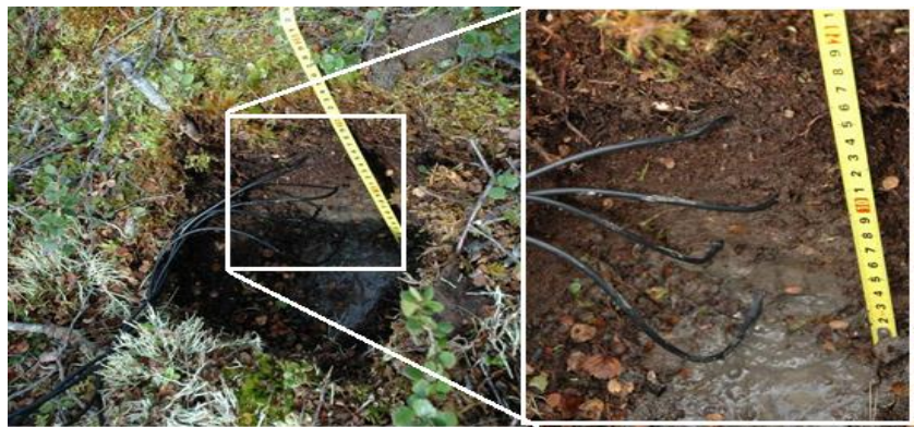
В) датчик для измерения влажности почвы
