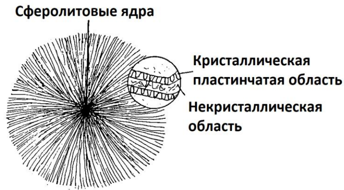
Рисунок 2 – Схематическое изображение сферолитовой структуры в полукристаллическом полимере ПВДФ [5]
